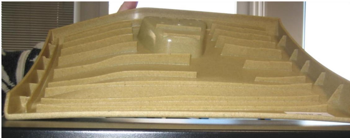
Obr. 2: Vypočítaná deformace PP dílu plněného sisalem a deformace reálného dílu. Deformace jsou shodné ve směru i velikosti.
