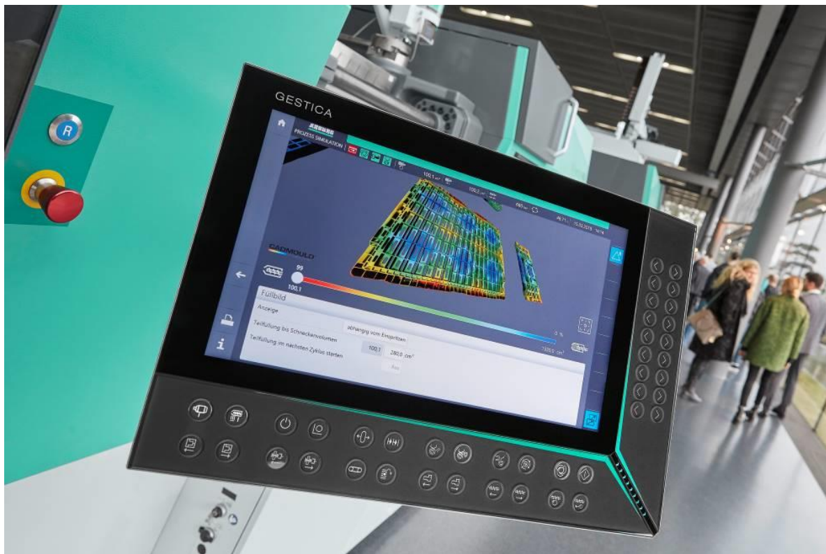
Obr. 3: Integrace simulace vstřikování do řízení vstřikovacího stroje, foto ARBURG
