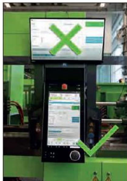
Další obrazovky jsou přebytné, internetové dashboardy je možné zobrazovat přímo na řízení CC300.
