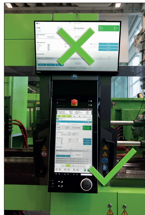
Další obrazovky jsou přebytečné, internetové dashboards je možné zobrazovat přímo na řízení CC300.
